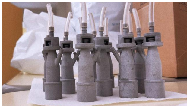
Rysunek 1 - Zawór oddechowy do aparatu oddechowego opracowany przez włoską firmę start-up.
