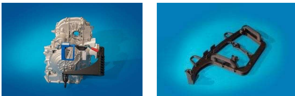
Figura 2 – Dispositivo di assistenza al montaggio, a sinistra, e lo strumento di allineamento dei finestrini, a destra, usati da Ford negli stabilimenti di assemblaggio.
