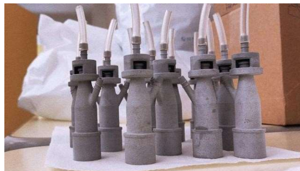
Figura 1 - Valvola respiratoria per dispositivi di ventilazione sviluppata da una start-up italiana.
