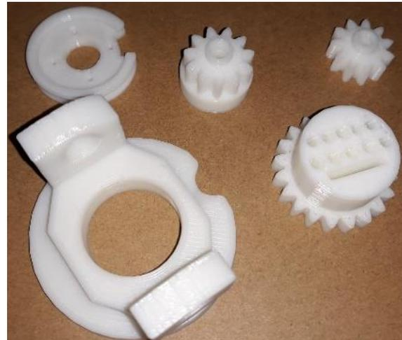
*Figura 17 – Partes hechas mediante impresión 3D*
