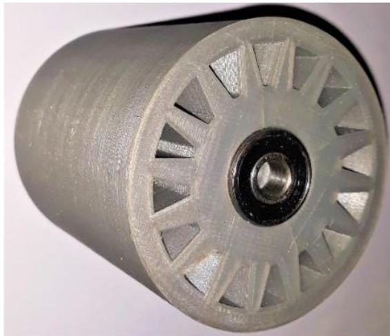
*Figura 16 – Prototipo creado mediante impresión 3D*
