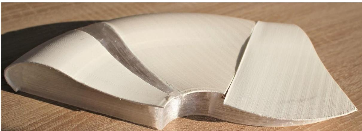
*Figura 19 – Modelo arquitectónico realizado mediante impresión 3D*
