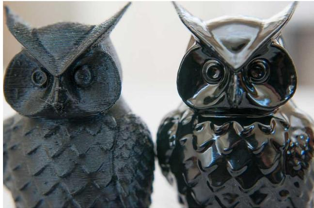
Figura 10 – Un objeto impreso en 3D, antes y después del alisado con vapor. Fuente: [www.qeetech.com](http://www.qeetech.com)
